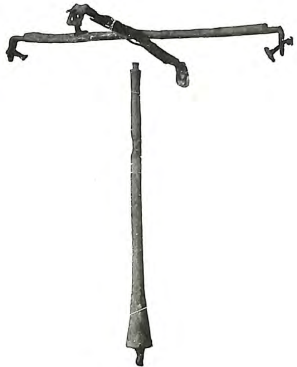
Fig. 6. Groma, gefunden zu Pfünz bei Eichstätt. in Seitenansicht.
