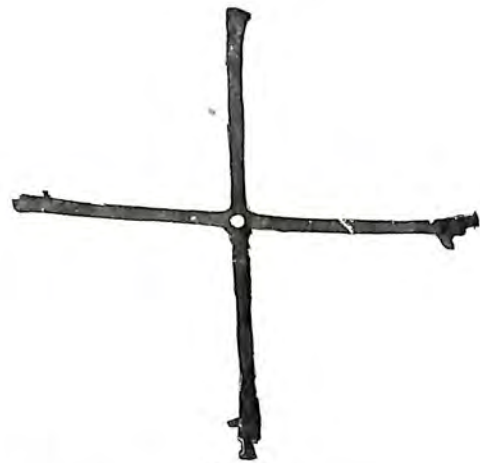
Fig. 7. Stella des Pfünzler-Instruments in Aufsicht.
